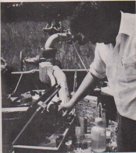
Control de la calidad química del agua durante un ensayo de bombeo.
